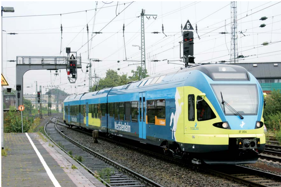
Abbildung 3: Dreiteiliger elektrischer Triebwagen FLIRT des Herstellers Stadler Rail, wie er seit Dezember 2007 von der WestfalenBahn im Teutoburger-Wald-Netz eingesetzt wird.
